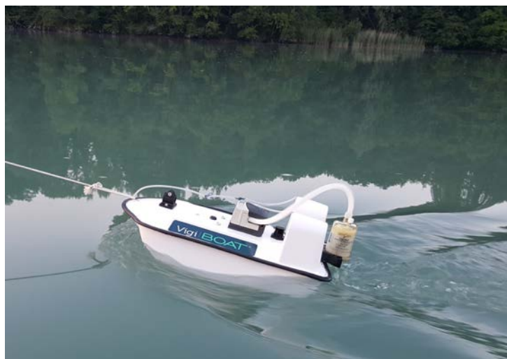
Figure 5 : Prélèvement ADNe en cours grâce au vigiBOAT sur le Rhône © CNR
